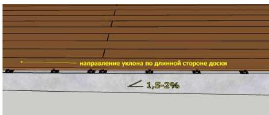
**6.4** Необходимо поддерживать чистоту в пространстве между структурными элементами товара (досками, панелями и т.д.), под ними для обеспечения беспрепятственного отвода дождевой и талой воды.
